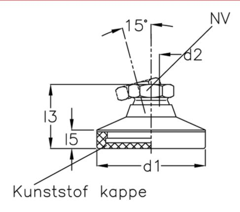
d1 = 60 d2 = 16 l3 = 37.5 l5 = 10 NV = 24 Static load (N) = 30 t min = 16
